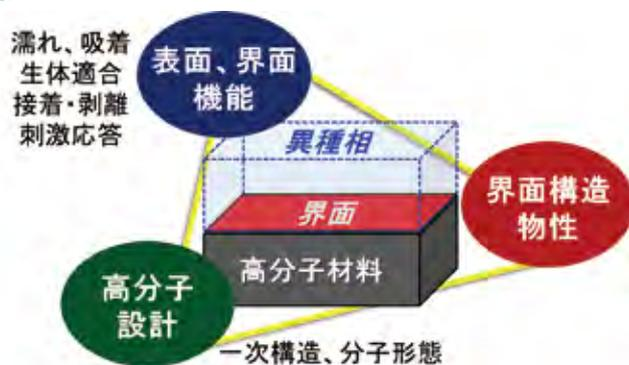
表面・界面制御に基づく機能性高分子材料設計の概念図
