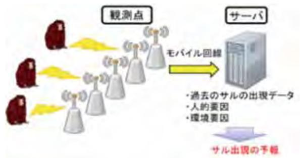
図1 サル接近検知システム
