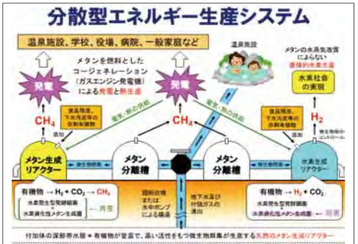
厚い堆積層の深部帯水層に由来する温泉メタンと温泉水に含まれる微生物群集を利用した分散型エネルギーシステム。水・ガス・電気・熱を自家供給することが可能です。巨大地震や洪水、大規模停電といった災害時にライフラインを確保する役割を担うこともできます。
