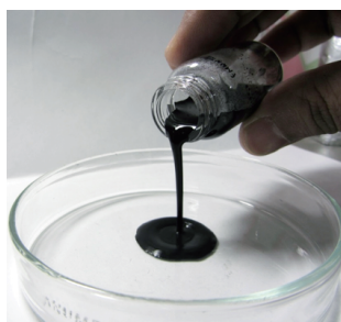
図1 水分散性ナノチューブ・インク。
