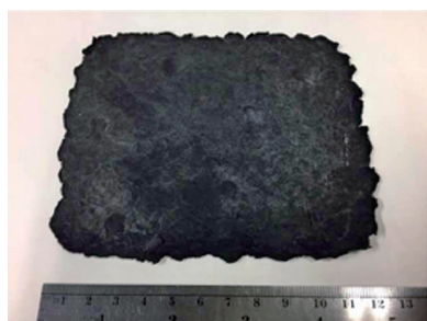
図2 導電性ナノチューブ・ペーパー。
