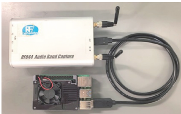
Raspberry Piによるデータ取得と異常検出装置
