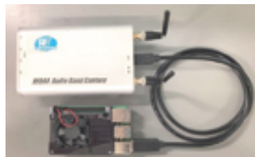
Raspberry Piによるデータ取得と異常検出装置
