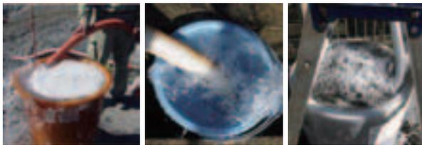
堆積層に構築された温泉用掘削井から湧出する温泉付随ガス(メタン=80~99%)
