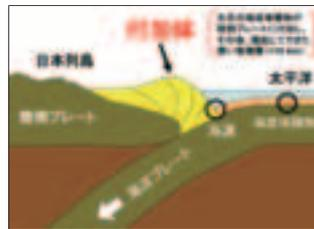
海洋プレートの沈み込みによって形成される付加体
