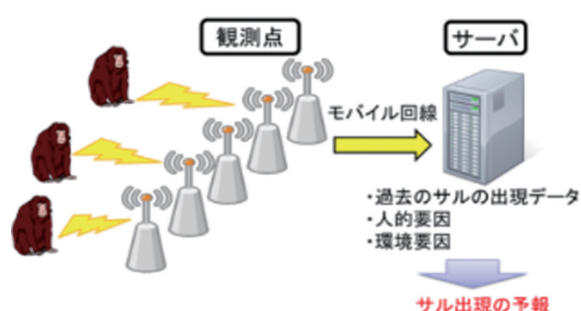
図1 サル接近検知システム
