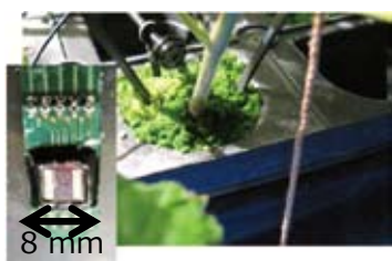
小型センサで少量培地にも挿入可能 （水分変動計測の様子）
