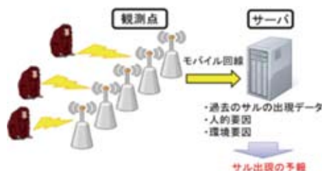
図1 サル接近検知システム
