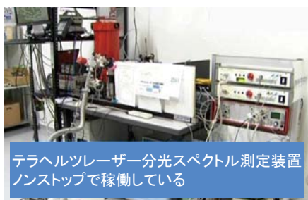
①テラヘルツレーザー分光スペクトル測定装置
