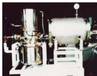
図2 JxB ナノチューブ、微粒子、フラーレン連続合成装置。
