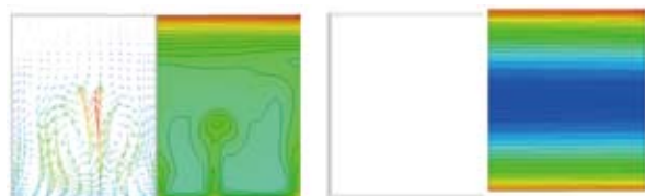
図2(左) 地上(1G)環境下の流れ模様と濃度分布(密度差対流の発生)。(右) 微小重力環境下の濃度分布(拡散律速)。
