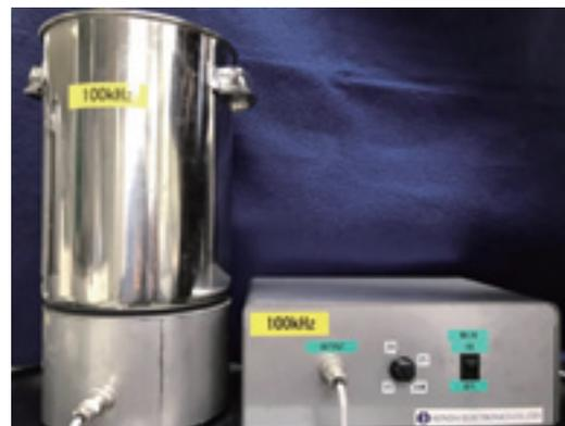
第4図 100kHzの超音波照射装置（本多電子株式会社）
