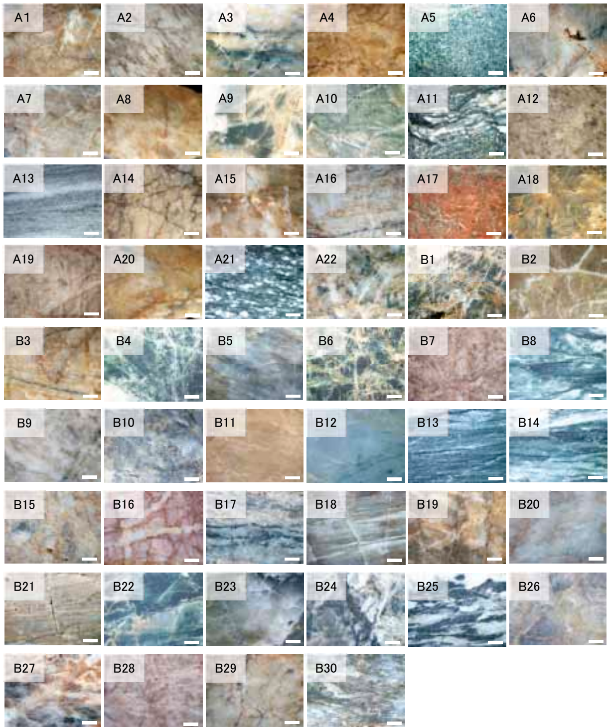
図3 本丸石垣に用いられた調査対象石材の研磨断面写真（スケールバー：2mm）
