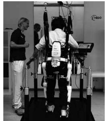
図7 CEマークを取得したロボットスーツHAL®医療用(ドイツのボーフムにあるニューロボットトレーニングセンター)
