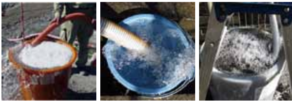
付加体の深部帯水層に由来する温泉付随ガス（メタンの割合、85-99%）
