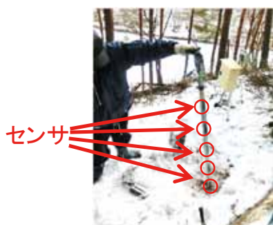
小型センサで多深度計測を実現 (雨水の浸透の様子を計測)
